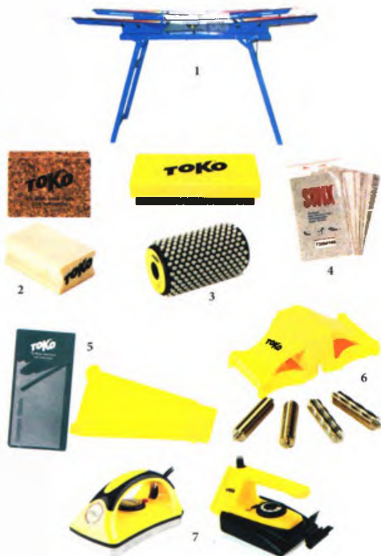
Рис. 41. Приспособления для подготовки лыж: стол-станок – 1, пробки – 2, щетки – 3, набор шкур – 4, скребки/цикли – 5, накатки – 6, смазочные утюги – 7
